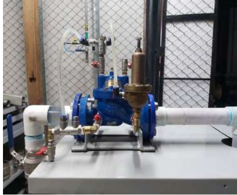
Figura 16. Montaje de VRP Singer y puesta a punto.
